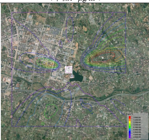
图 6.1.2-10 \text{NO}_2 日均浓度等值线分布图 (单位: \mu\text{g}/\text{m}^3 )
