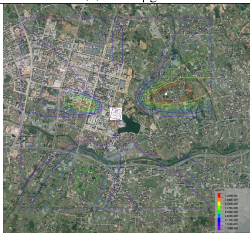
图 6.1.2-17 Hg 日均浓度等值线分布图 (单位: \mu\text{g}/\text{m}^3 )
