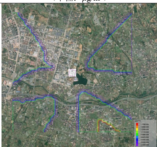
图 6.1.2-26 Cd 年均浓度等值线分布图 (单位: \mu\text{g}/\text{m}^3 )
